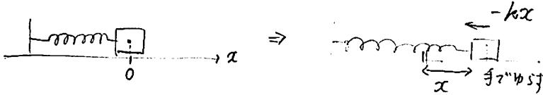
$$m\ddot{x} = -kx + f(t) \quad f(t): \text{手で加えた力}$$
